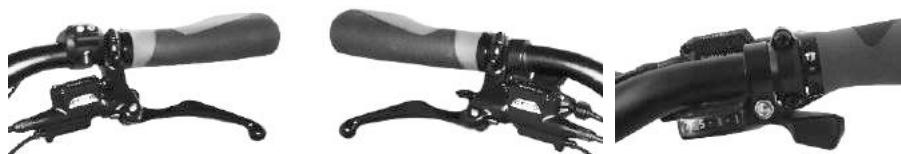
만약 브레이크 레버를 손잡이와 달게 너무 세게 당기면 브레이크의 기능을 다할 수 없으며 브레이크 제동 거리 증가를 야기시켜 사고를 유발 할 수 있습니다. 위의 설명대로 브레이크 레버를 조정해 주세요.
