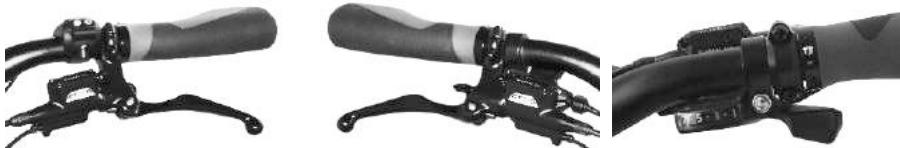
如果您拉煞車控制桿至手把，用力煞車時，您不能將它的煞車力加到全滿。它將導致煞車的距離增加，會有意外的危險。請依據以上所述的調整煞車桿。
