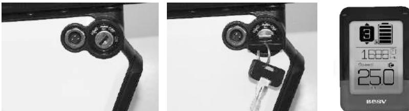
**Einschalten:** Stellen Sie sicher, dass der Akku korrekt am Fahrrad montiert ist und der Ein-Aus-Schalter auf „ON“ (rot) steht. Über das Display können Sie prüfen ob das System eingeschaltet ist. Die Startanzeige auf dem Display sieht wie auf dem Bild dargestellt aus. Es werden Unterstützungsstufe, Akkuladezustand, Gesamtkilometer und Geschwindigkeit angezeigt.
