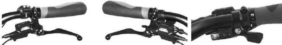
Se si tirano le leve del freno troppo vicino alla manopola, quando si frena violentemente potrebbe non essere possibile usare il freno fino in fondo. Questo aumenta la distanza di frenata, causando il rischio di incidenti. Si prega di regolare le leve del freno come detto prima.
