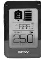
**Aanzetten:** Verzeker u ervan dat de accu goed is geïnstalleerd en er op het accuvergrendeling het rode lampje "ON" brandt, dat de meters zichtbaar zijn, en dat het systeem aanstaat. Op de meters verschijnt het hoofdmenu met een afbeelding, met de ondersteuningsstand, de accumeter, de totale afstandmeter en de snelheidsmeter.
