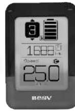
ON: Verificare che la batteria sia stata installata e l'avviamento della batteria si trovi in posizione "Rosso On"; si può quindi verificare che il pannello di controllo si sia acceso e che se il sistema si sia avviato. Quando nel pannello di controllo appare la schermata principale come nell'immagine, è possibile visualizzare il livello di assistenza del motore elettrico, il livello della batteria, il chilometraggio totale e la velocità.
