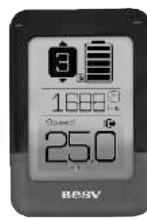
**ВКЛ:** Убедитесь, что аккумулятор установлен в велосипед, а замок аккумулятора повернут в положение «ON (красный)». Экран начнет работать. Проверьте, включена ли система. Программа выводит главную страницу, как показано, включая уровень поддержки, мощность аккумулятора, общее расстояние и скорость. Важно: фоновая подсветка программы выключается автоматически через 10 секунд для сохранения энергии.
