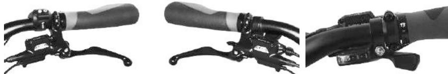
如果您拉煞车控制杆至手把，用力煞车时，您不能将它的煞车力加到全满。它将导致煞车的距离增加，会有意外的危险。请依据以上所述的调整煞车杆。
