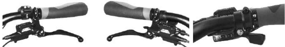
При резком торможении нажатием на тормозную рукоятку вы не должны давить на нее с максимальной силой. Иначе тормозной путь будет увеличен, что создаст риск аварии. Отрегулируйте тормозные рукоятки, как указано выше.
