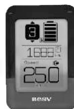
**開啟：**請確認電池安裝在車上並將電池鎖轉至“紅色ON”位置，可看見儀表顯示，確認系統是否開啟。
