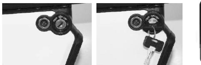
**챙기 :** 배터리가 전동 보조 자전거에 부착이 되어있는지를 확인하고 배터리 잠금을 '빨간색 ON'으로 들리시면 계기판이 켜지며 시스템이 작동 하는지를 확인 하실 수 있습니다. 이때 계기판의 메인 화면이 켜지며 아래의 제일 오른쪽에 있는 사진과 같이 배터리의 전력 사용량이 계기판에 표시 됩니다. 주의 : 배터리의 전원을 절약하기 위해 계기판의 백라이트는 10초 후에 자동으로 꺼집니다.
